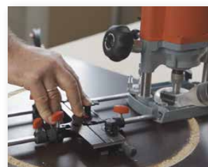
El adaptador para fresadora Mafell LO-FA puede usarse como tope de bolsillo para fresar, adaptador de carril guía, valla de desgarre o brújula.
