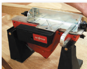
Enhandshyvel MHU 82 med stationär anordning och pendelskyddskåpa.
