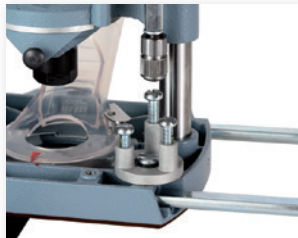
Snabb inställning av fråsdjupet med hjälp av steglöst inställbar 3-faldigt revolver anslag.
