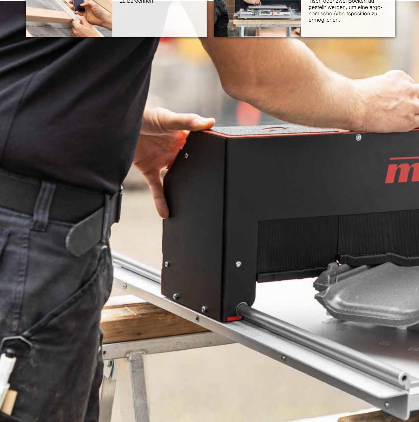
**Das Ziegel-Anreiß-System ZAS macht das Eindecken von Dächern mit Schnittziegeln, wie man es bei Kehle oder Grat kennt, denkbar einfach, sicher und schnell. Damit gehören aufwändige Zuschnittsarbeiten auf dem Dach der Vergangenheit an.**
