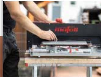
Die Ziegel werden im Vorfeld, bei sicherem Stand, mit der Ziegel-Anreiß-Schablone angerissen. Die Schablone kann auf einen Tisch oder zwei Böcken aufgestellt werden, um eine ergonomische Arbeitsposition zu ermöglichen.
