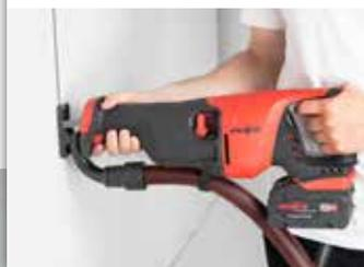
Les copeaux et les particules de poussière sont aspirés directement de la lame de la scie par les manchons d'aspiration ajustables.
