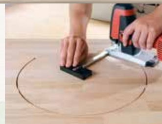
Fonction compas (rayon entre 50 et 210 mm)
