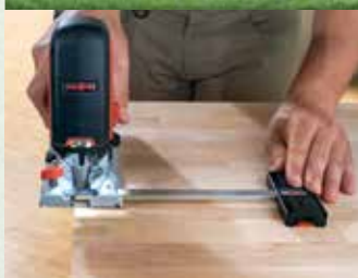
Apoyo adicional / estabilización
