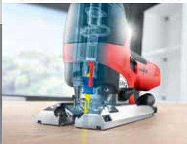
Le système de tension de lame breveté *CUmax* retient la lame de scie en l'empêchant de bouger. Pas de dégagement de chaleur dû à la friction. Fini le temps des lames de scie déformées.
