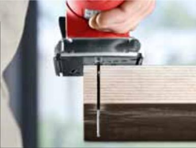
Grâce à son centre de gravité bas et à sa plaque de base extrêmement stable et large, la P1 cc repose de manière perpendiculaire et sécurisée sur la pièce : Ceci garantit un maximum de précision et une utilisation confortable.
