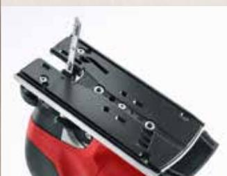
Avec sa fermeture rapide, la plaque de base se trouve toujours à 100 pour cent perpendiculaire sur la scie sauteuse. Les plans d'appui largement dimensionnés facilitent le travail pour les petits écarts d'angles et de bords.
