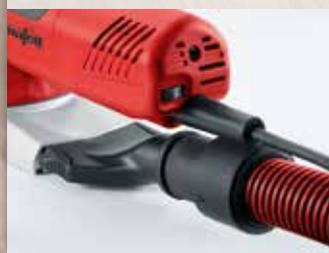
Le canal d'aspiration intégré dans la plaque de base assure une excellente aspiration, directement sur la lame de scie, grâce au principe Venturi. La fissure est soufflée d'un côté et aspirée du côté opposé. Une fissure reste ainsi exempte de copeaux et toujours bien visible, même sans aspirateur raccordé.
