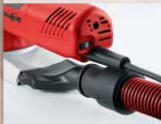
Der in die Grundplatte integrierte Absaugkanal sichert durch das Venturi-Prinzip eine hervorragende Absaugung direkt am Sägeblatt. Der Riss wird von einer Seite freigeblasen und von der gegenüberliegenden abgesaugt. So bleibt der Anriss frei von Spänen und ist auch ohne angeschlossenen Staubsauger immer gut zu sehen.
