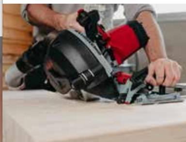
La NFU 50 si può anche usare come fresatrice per tacche di controcatena. Lo strumento online per calcolare i valori di regolazione è disponibile nel seguente codice QR/link.
