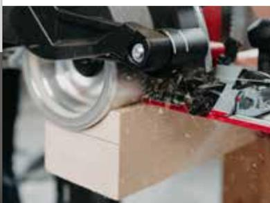
La potenza concentrata e la grande forza di trascinamento della NFU 50 consentono fresature di 60 mm di larghezza e 50 mm di profondità.
