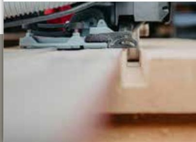
Mit dem im Sonderzubehör erhältlichen Verstellnuten können Nuten zum Beispiel für Versorgungsleitungen effektiv und schnell eingefräst werden.
