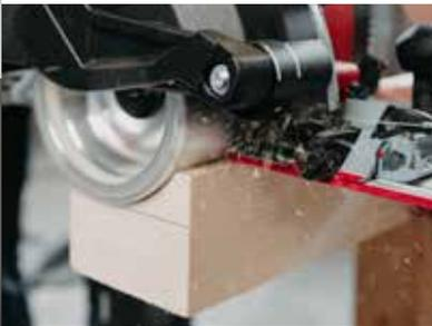
Die geballte Power und hohe Durchzugskraft der NFU 50 lassen Fräsungen mit einer Breite von 60 mm und einer Tiefe von 50 mm zu.
