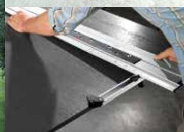
Pour les coupes transversales en équerre, par ex. sur les plinthes ou baguettes de finition.
