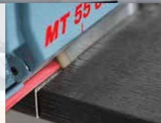
La MT 55 est une scie polyvalente de haute précision: elle réalise des coupes plongeantes, de séparation, biaisées et d'angle sans éclats. Elle scie les panneaux d'aggloméré, multiplex, multiplis, trois plis, OSB, de staff, tendre, panneaux de fibrociment et stratifiés avec autant de précision que le bois massif, le plexiglas, l'aluminium, les profilés en aluminium, l'aggloméré laminé et les dalles.
