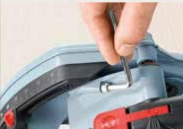
Pour le réajustage précis du réglage de profondeur de coupe, par ex. après l'affûtage des lames ou pour du Fermacell.
