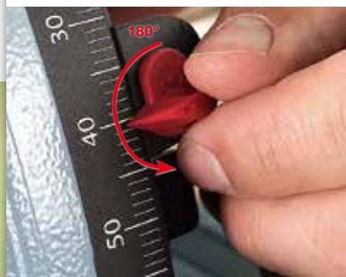
La profondeur de coupe s'ajuste au millimètre près. Avec ou sans règle – il suffit de tourner l'indicateur de profondeur de coupe pour qu'il affiche toujours la position exacte de la lame de scie.
