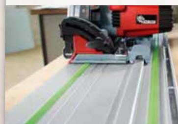
Le guidage de la règle est intégré à la plaque de base en magnésium coulé sous pression de la MT 55 cc. Grâce à la seconde rainure de guidage dans la plaque de base et aux mâchoires de guidage réglables, la MT 55 cc s'adapte parfaitement aux règles d'autres fabricants.
