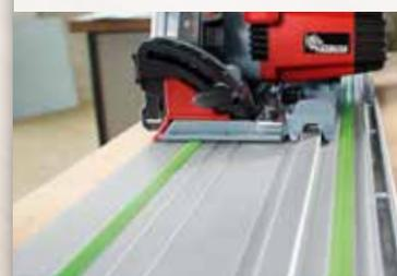
La guía está integrada en la placa base de fundición a presión de magnesio de la MT 55 cc. Gracias a la segunda ranura de guía en la placa base y a las mordazas de guía regulables también se puede adaptar la MT 55 cc con precisión a sistemas de guía de otros fabricantes.
