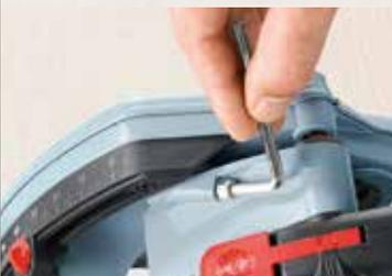
Para volver a ajustar la profundidad de corte con absoluta precisión, por ejemplo, cuando se reafilan hojas de sierra o en el caso de Fermacell.
