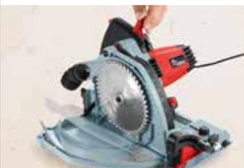
Para el cambio de hoja de sierra más rápido del mundo: sólo tiene que pulsar el botón de desbloqueo y levantar la palanca. La carcasa se abre y entonces se puede cambiar la hoja de sierra al instante. Con la cubierta de la hoja de sierra abierta, están activados automáticamente el bloqueo de conexión y el de la hoja de sierra.
