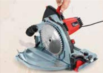
Für den schnellsten Sägeblattwechsel der Welt: Einfach Entriegelungsknopf drücken und Hebel anheben. Die Schutzhaube öffnet sich und das Sägeblatt kann im Handumdrehen gewechselt werden. Bei geöffneter Schutzhaube sind automatisch die Einschaltsperre sowie die Sägeblattparrettierung aktiviert.
