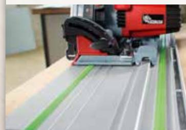
Die Schienenführung ist in der Magnesiumdruckguss-Grundplatte der MT 55 integriert. Dank der zweiten Führungsnut in der Grundplatte und den einstellbaren Führungsbacken lässt sich die MT 55 auch an Schienensysteme anderer Hersteller exakt anpassen.
