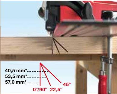
Bei einer Blattstellung von 0° sind Schnitttiefen bis 57 mm\* möglich. Durch das innovative Schwenksystem sind selbst bei Schrägschnitten kaum Grenzen gesetzt. Bei 45° Grad beträgt die Schnitttiefe immer noch 40,5 mm\*.
