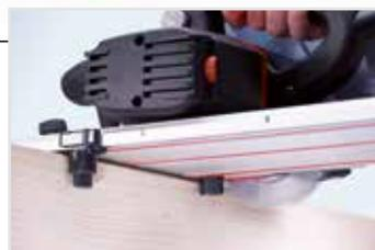
trouvent des butées dont l'angle peut être réglé par échelonnage. Après utilisation, un ressort remet la fraise dans sa position initiale.
