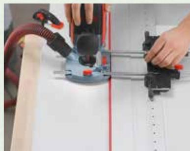
In combinazione con l'adattatore della fresatrice verticale LO-FA e la guida F-LR, è in grado di eseguire file di fori in modo sicuro e preciso. Per avanzare rapidamente nel lavoro, è sufficiente disattivare il fissaggio Permafix.
