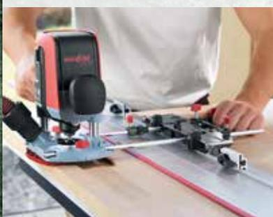
In combinazione con l'adattatore per fresatrice verticale LO-FA, è possibile, ad esempio, creare bordi fresati per impugnature in modo preciso e semplice.
