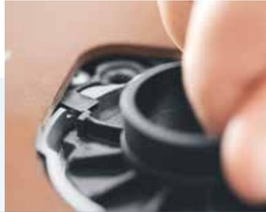
Una volta inserito, l'anello di copiatura viene centrato automaticamente con l'alloggiamento calibrato in fabbrica. In questo modo si elimina il lungo e costoso processo di allineamento.
