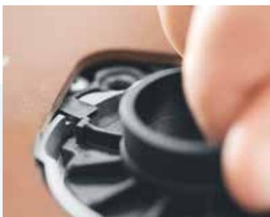
La bague de copiage se centre automatiquement dans le logement calibré en usine, éliminant ainsi le long et fastidieux processus d'alignement.
