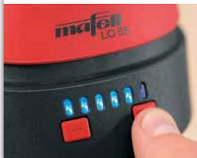
Le tableau de bord numérique MAFELL IPC constitue la nouvelle électronique. Il incorpore une technologie de commande pour la protection contre les démarrages incontrôlés et contre la surcharge ainsi que pour le maintien de vitesses constantes en charge. Les LEDs de couleurs informent des fonctions et des états de fonctionnement.
