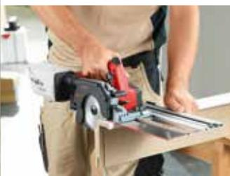
Con una profundidad de corte de hasta 42 mm, la nueva KSS 40 18M bl cubre hasta un 80 por ciento de las aplicaciones en obras y garantiza un corte limpio - con el alto rendimiento habitual de MAFELL.
