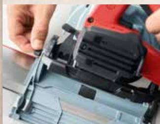
El centro de gravedad de la KSS 300 se encuentra lateralmente en el canto inferior de la guía. Así, existe un solo indicador de proyección, ya sea en ajuste angular, con o sin guía.
