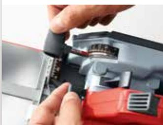
La profundidad de corte se puede ajustar rápidamente sin escalonamiento. La profundidad se regula con una escala tras soltar la sujeción.
