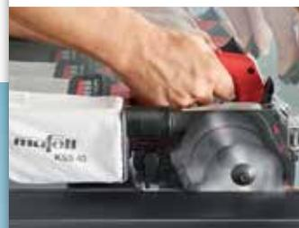
Con la guía de altura de columna se pueden realizar cortes de inmersión con facilidad y precisión. El FLIPPKEIL elástico permite trabajar de forma segura incluso sin desatornillar el cuchillo separador.
