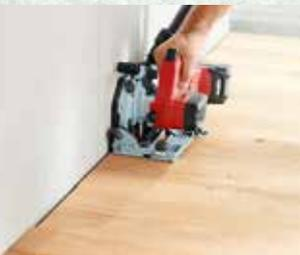
La forma constructiva de la sierra circular manual permite efectuar trabajos cercanos al borde y garantiza la fácil ejecución de ranuras con bisel y juntas de dilatación exactas a partir de 13 mm de ancho.
