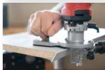
La grande surface de support permet d'usiner en toute sécurité, même des chants inclinés.
