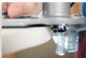
Le frein de l'anneau de butoir évite de laisser des marques d'usinage peu esthétiques sur les matériaux sensibles.
