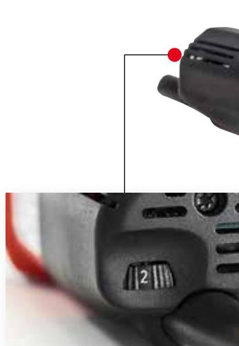
Las revoluciones se pueden ajustar sin escalonamiento para obtener una velocidad óptima de fresado.
