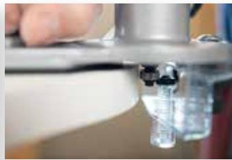
El freno del anillo de tope evita dejar marcas de mecanizado poco atractivas en materiales sensibles.
