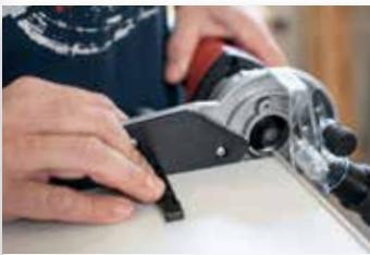
El tope insertable garantiza un guiado seguro en el mecanizado de esquinas.
