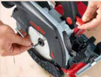
Pour un changement de lame, la lame de la scie est bloquée par simple pression d'un bouton et le blocage de mise en marche est activé automatiquement. La lame peut être alors remplacée aisément et sans danger à l'aide de la clé à six pans fixée à l'appareil.
