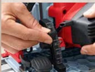
Grâce au système pivotant unique en son genre, une profondeur de coupe de 42 mm (règle comprise) peut être toujours atteinte pour des angles compris entre 0° et 45°.
