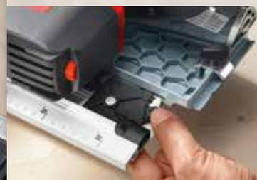
Par simple pression d'un bouton, la machine peut être séparée de la règle de guidage et utilisée avec toutes les possibilités d'application de la KSS 50.
