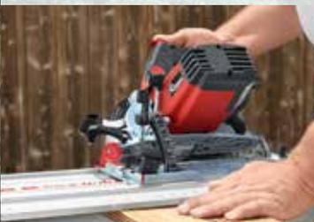
Grâce à la graduation angulaire de grande dimension, des coupes en onglet parfaitement ajustées peuvent être réalisées. Comme ici à l'exemple d'un bardage.
