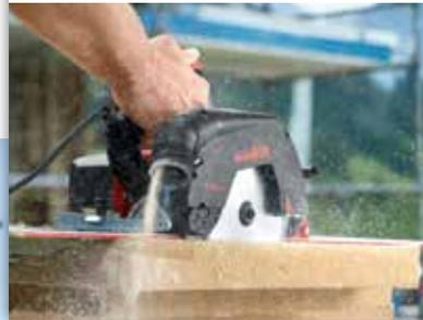
Die Spanführung wurde gezielt für ein extrem hohes Spanvolumen beim Schneiden von Holzfaserverwerkstoffen konzipiert und optimiert. Das ermöglicht ein verstopfungsfreies Arbeiten – auch bei Tauchschnitten in Faserrichtung.
