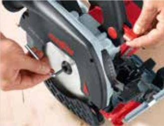
Zum Sägeblattwechsel wird das Sägeblatt einfach per Knopfdruck arretiert und dabei automatisch die Einschalt-sperre aktiviert. Das Sägeblatt lässt sich dann mit dem am Gerät befestigten Sechskant schlüssel sicher und gefahrlos austauschen.
