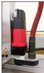
Il fissaggio è possibile tramite il collare di serraggio o, in alternativa, tramite un collegamento a vite diretto al portale.
