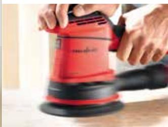
La levigatrice EVA 150 E è stata studiata per un utilizzo professionale e intenso. Gli assorbitori di vibrazione isolano le posizioni di presa per evitare la trasmissione delle vibrazioni all'operatore, per garantire un ambiente di lavoro più salubre e comodo.
