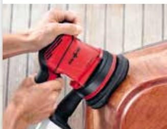
Per la lavorazione di superfici concave e convesse è disponibile un pratico supporto di spessore con strato morbido. Il pad in materiale espanso crea un appoggio lineare per ottenere risultati di levigatura uniformi e regolari.
