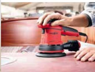
La EVA 150 E / 3, con su carrera oscilante de 3 mm, resulta ideal para el lijado fino o el lijado intermedio de lacado.
