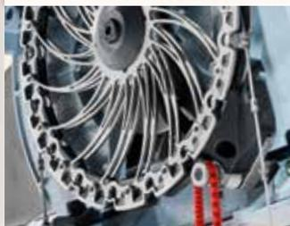
Volant de renvoi du câble possède un logement en deux parties pour les maillons de la scie et de l'entraînement. Les racleurs en haut et en bas de la roue empêchent un dépôt de copeaux et veillent à un guidage exact du câble.
