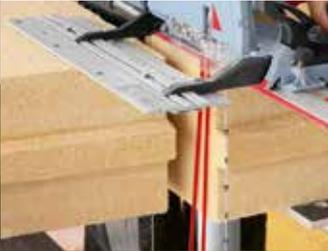
Grâce à la parfaite interaction de tous les composants du système et aux détails innovants, tels que câble de sciage, onglel couteau diviseur en carbone et racleurs de copeaux, il est possible d'obtenir une qualité de coupe ultra-précise.
