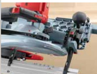
La DSS 300 cc autorise un angle d'inclinaison allant jusqu'à 60°. Le câble de sciage et le couteau diviseur peuvent, par ailleurs, pivoter jusqu'à 45° vers l'arrière.
