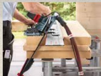
Grâce à la parfaite interaction de tous les composants du système et aux détails innovants, tels que câble de sciage, onglet de guidage en carbone et racleurs de copeaux, il est possible d'obtenir une qualité de coupe ultra-précise.
