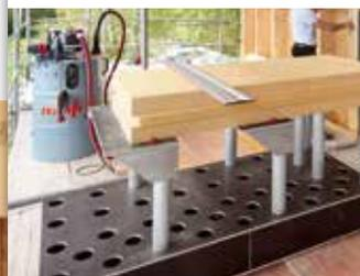
Coupes longitudinales, transversales ou biaisées : le système enfichable pour les matériaux isolants rigides et souples peut être ajusté à chaque situation de coupe. Même sur un échafaudage.
