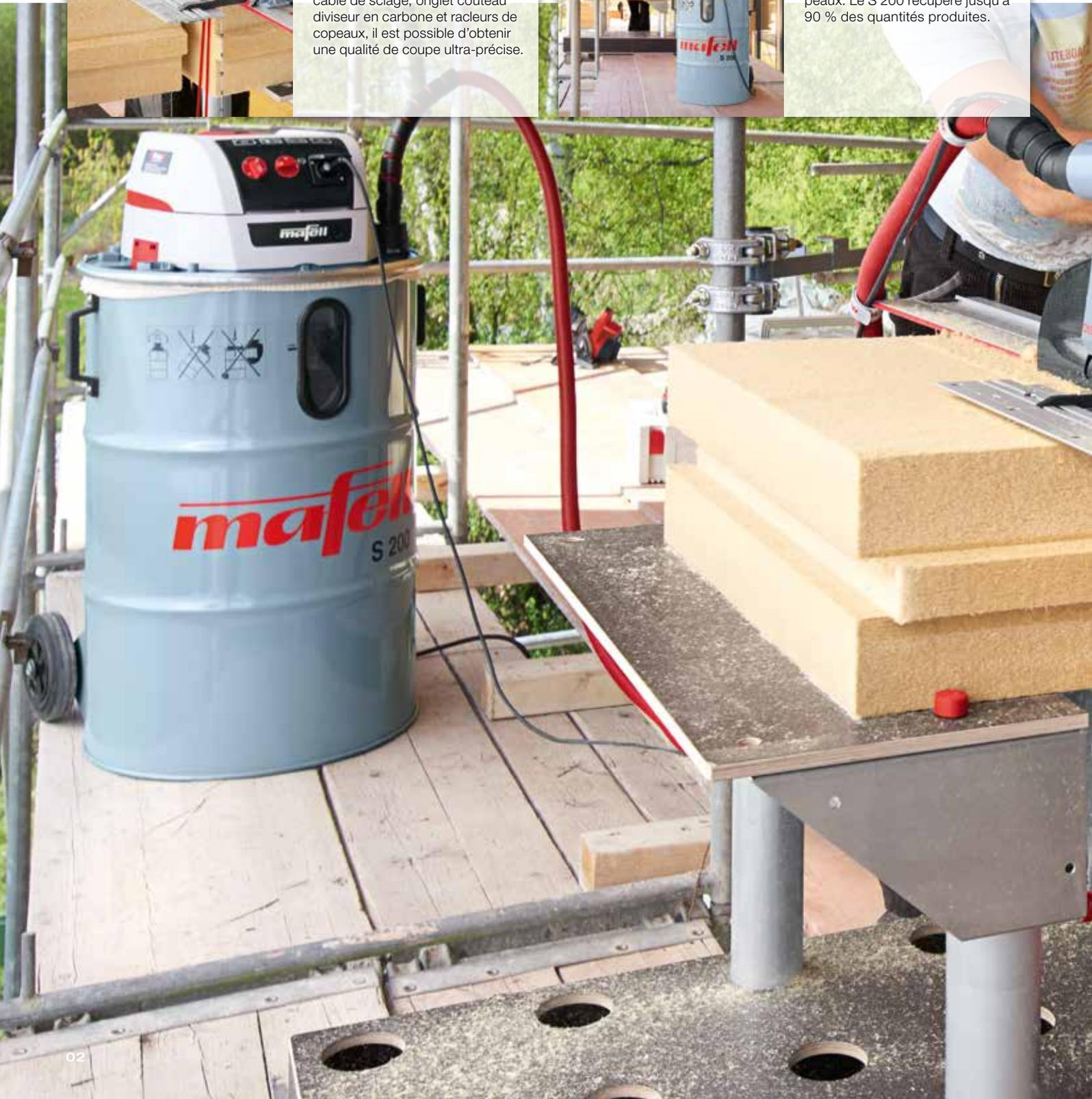
**MAFELL propose, avec la DSS 300 cc, une scie à câble inédite, servant à l'usinage des matériaux isolants à fibres de bois rigides et souples. Les résultats de coupe précis et parfaitement ajustés améliorent le pouvoir isolant et réduisent les ponts thermiques ainsi que les dommages de construction. La DSS 300 cc contribue ainsi fortement à la mise en œuvre rentable de travaux d'isolation performants.**
