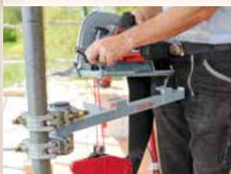
Le support-machine S200-MH permet de positionner solidement la DSS 300 cc soit sur l'aspirateur soit sur l'échafaudage – à l'aide de colliers pour échafaudage.
