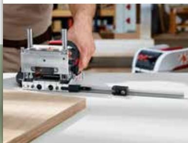
El sistema de topes patentado con clavijas elásticas de tope en la placa base se ha adaptado fácilmente para el nuevo tope lateral SA 320. Esto permite colocar pares de agujeros a una mayor distancia del canto de referencia con suma facilidad, repetibilidad y sin trazado.
