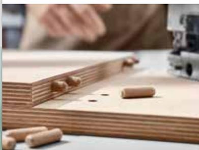
Los taladros en pasos de 32 mm son parte del trabajo diario de un profesional. Si se utiliza otro sistema de mechonado, se requiere siempre un aparato adicional. El Duo Mechonador DDF 40 también permite colocar filas de agujeros y taladros de herrajes de 32mm – y montar muebles completos.
