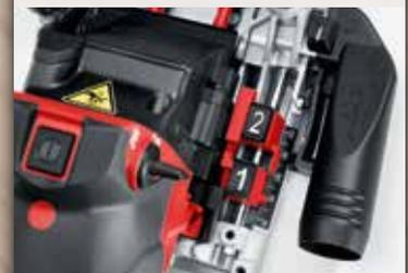
Con los topes de profundidad "1" y "2" se pueden ajustar dos profundidades de taladro. Estas se preseleccionan con el botón giratorio. Además, este botón ofrece un ajuste para el cambio de herramienta que bloquea automáticamente el interruptor de conexión.
