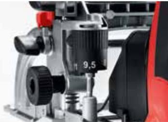
La altura del tope giratorio se ajusta con una rueda y escala con gran precisión dimensional hasta 62 mm. Las medidas habituales se pueden preajustar mediante el tope de revólver.
